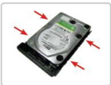
Krok 3. Umieść dysk w kieszeni, i przykręć na cztery śruby
