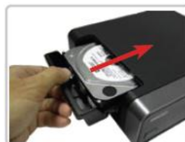
Krok 4. Wsuń kieszeń do odtwarzacza.
