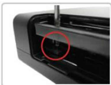
Krok 5. Przykręć kieszeń aby ją zabezpieczyć
