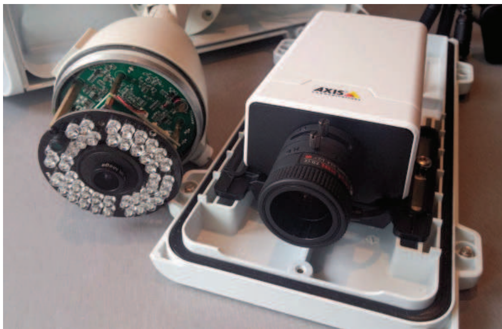
Kamera Grandstream GXV3672 FHD 36 (po lewej stronie) kusi wysoką rozdzielczością pracy (2048 × 1536 pikseli) i przystępną ceną. W praktyce jakość nagrań jest jednak przeciętna, bo kamera wyposażona jest w niewielki i tani obiektyw. Dla porównania, po prawej stronie widoczna jest dwukrotnie droższa kamera Axis M1124-E, która – choć pracuje w dużo niższej rozdzielczości (720p) – oferuje lepszą jakość nagrań. Już na pierwszy rzut oka widoczny jest większy obiektyw.
