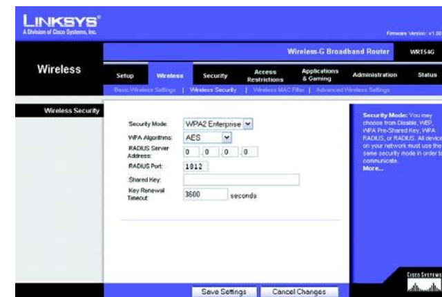
Rysunek 6-20: Zakładka Wireless – Wireless Security (WPA2 Enterprise)
