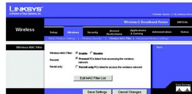
Rysunek 6-23: Zakładka Wireless- Wireless MAC Filter
