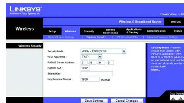
Rysunek 6-18: Zakładka Wireless – Wireless Security (WPA Enterprise)
