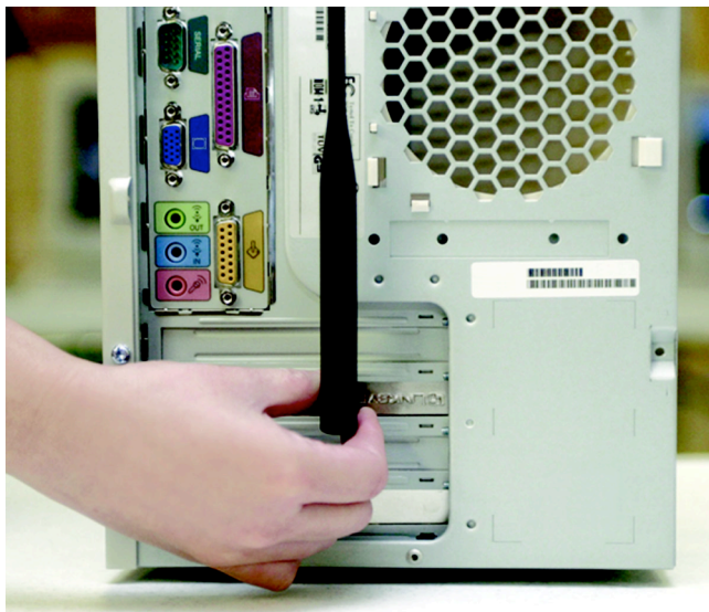
Rysunek 4-2: Prawidłowa pozycja anteny
