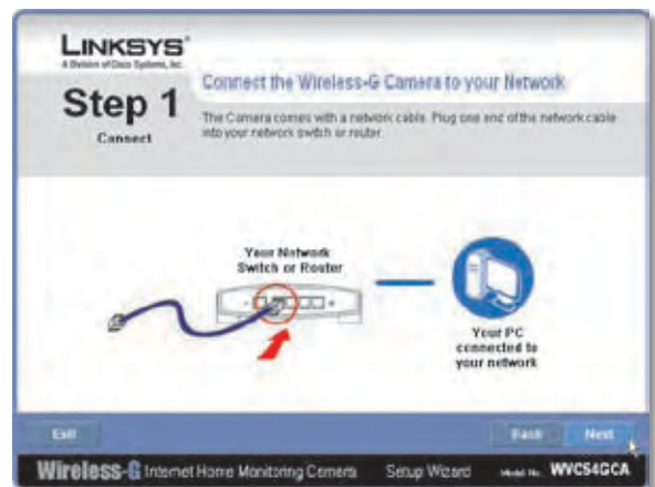
Sluit de netwerkkabel aan op de netwerkswitch of -router
