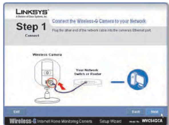
Netzwerkkabel an die Kamera anschließen
