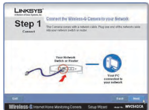
Ligar o cabo de rede ao switch ou router
