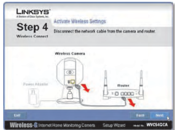
Déconnexion du câble réseau
