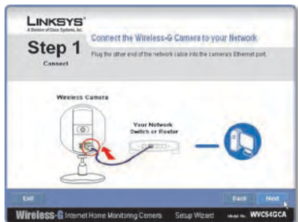
Conexión del cable de red a la cámara
