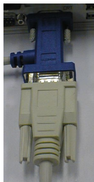
Rys. 4 Podłączenie do komputera stacjonarnego z monitorem
